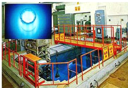
ガンマ線照射のための水プール施設とコバルト60ガンマ線源付近から放射されるチェレンコフ光
