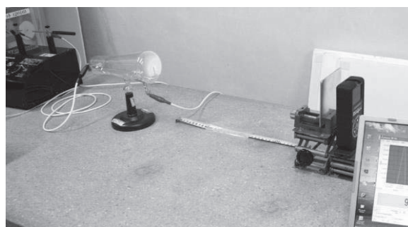
図 4. クルックス管からの X 線を Al 板で遮蔽しての測定体系。図 3 の結果は距離 50cm の場合。
