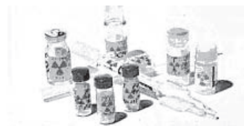
図6 トレーサー実験に用いられる RI 標識化合物
